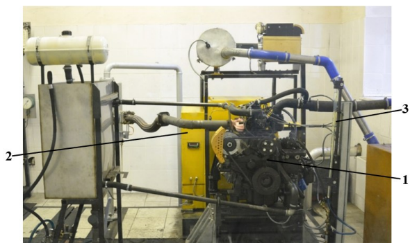
Рис. 4. Моторная установка: 1 – дизель; 2 – динамометрическая машина; 3 – расходомер топлива
