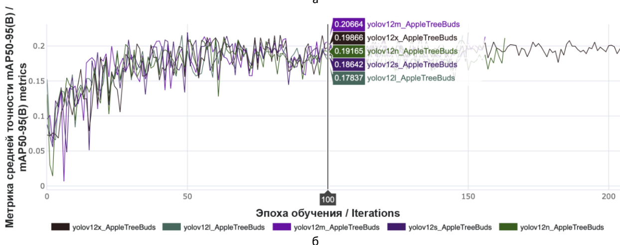
Рис. 2. Зависимость средней точности моделей от количества эпох обучения: а – метрика mAP50, б – метрика mAP50-95
