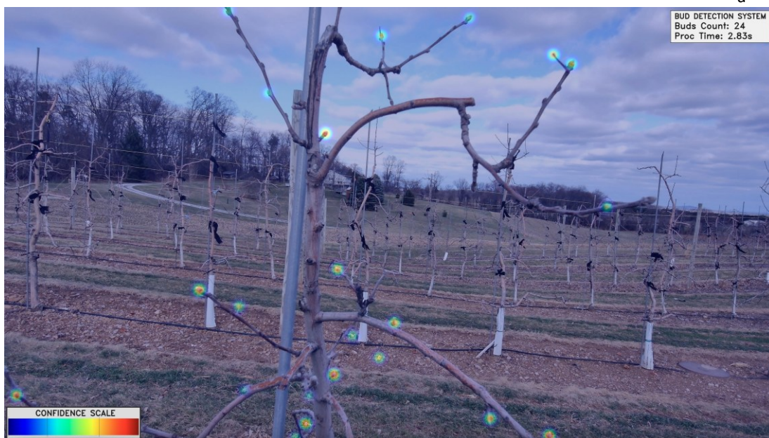
Рис. 4. Пример распознавания изображений с использованием обученной модели YOLO12x: а – аннотированное изображение с ограничивающими прямоугольниками (Bounding Boxes), б – тепловая карта уверенности модели (Confidence Heatmap)
