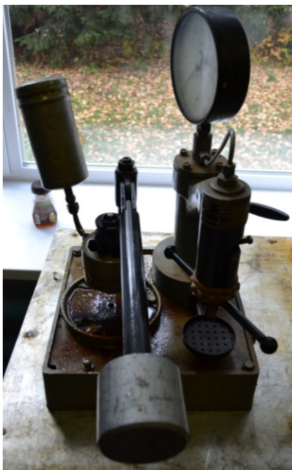
Рисунок 1 – Приспособление КИ-759 для испытания плунжерных пар на гидравлическую плотность
