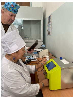
Рисунок 3 – Исследование молока на анализаторе «Эксперт Супер Плем-К»
