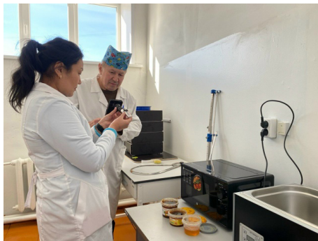
Рисунок 2 – Исследование меда рефрактометром RHB-90ATC
