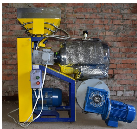
Рис. 2. Модернизированный одношнековый экструдер ЭК-40 с вакуумной камерой
