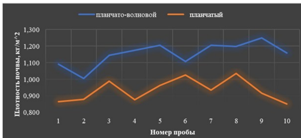
Рис. 5. Результаты замеров плотности почвы после прохода исследуемых катков
