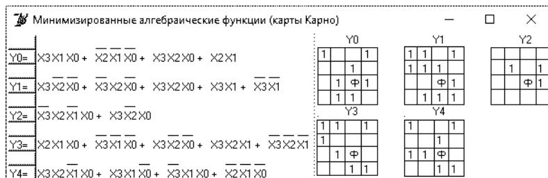
**Рис. 3. Минимизированные булевые функции и карты Карно**
