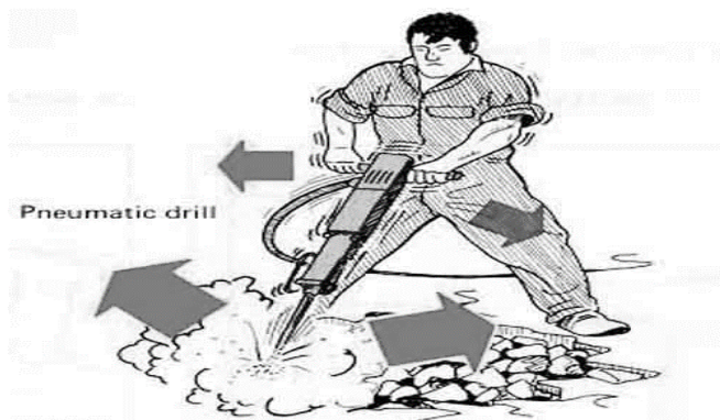
Рис. 1- Пример воздействия местной вибрации, передающееся на руки человека
