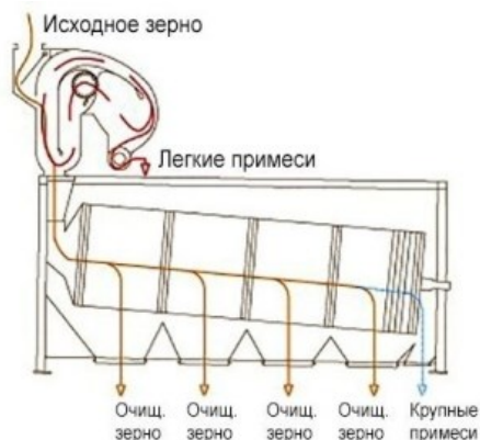
Рис. 1. Схема предварительной очистки зерна
