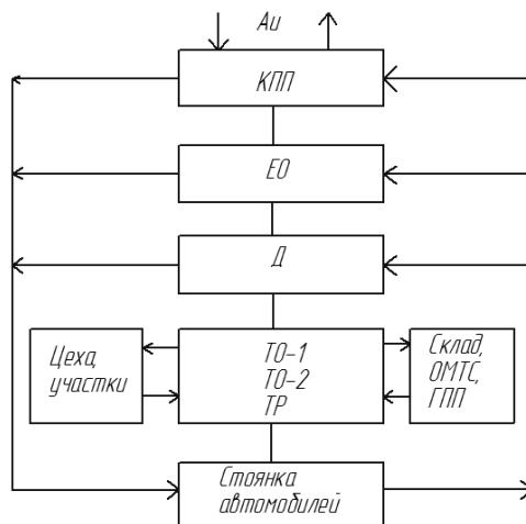
Аи — исправные автомобили; КПП — контрольно-пропускной пункт; ЕО — ежедневное обслуживание; Д — участок диагностирования; ТО-1, ТО-2 — техническое обслуживание № 1 и 2 соответственно; ТР — текущий ремонт; ОМТС — отдел материально-технического снабжения; ГПП — группа подготовки производства
