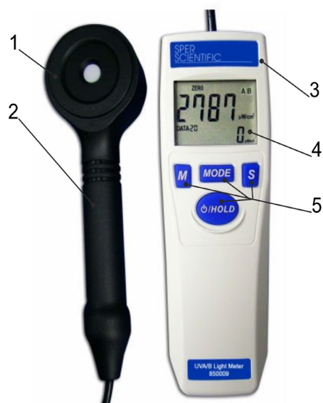
Рис. 2 - Прибор для измерения интенсивности бактерицидного излучения Sper Scientific UVC Light Meter (Model 850010): 1 – сенсор; 2 – кожух; 3 – корпус; 4 – дисплей; 5 – кнопки управления
