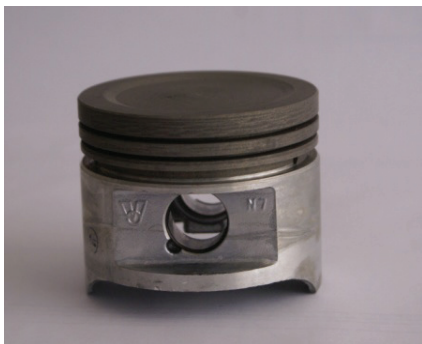
Рисунок – Упрочняющее покрытие на днище и головки поршня
