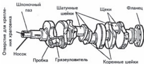
Рисунок 2 – Устройство коленчатого вала
