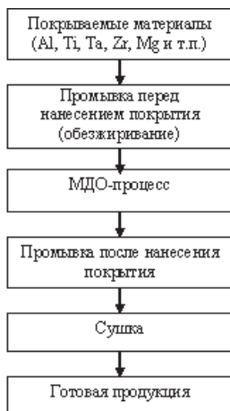
Рисунок 1 -Последовательность технологических операций при МДО
