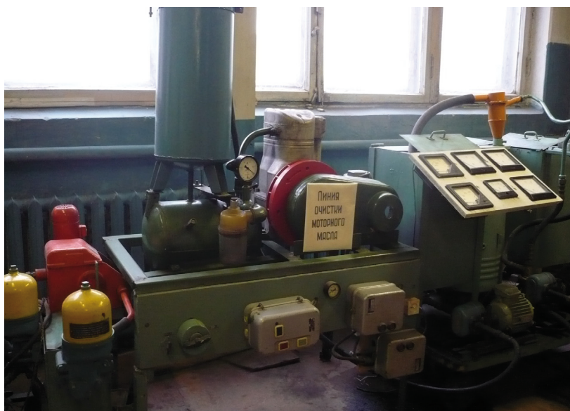
Рис. 2 – Универсальная установка для очистки моторного масла (обозначения в тексте): а – принципиальная схема; б – фото установки
