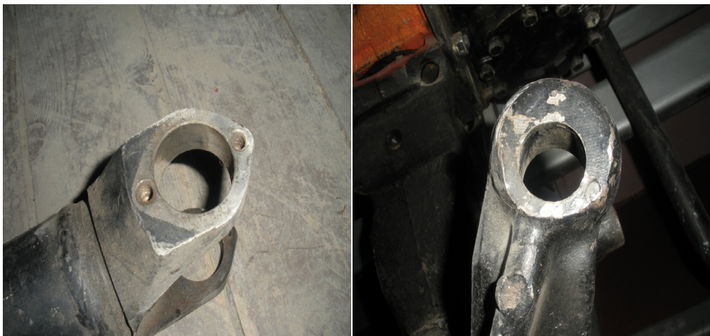
Рис. 2 - Детали, имеющие неравномерный износ отверстия:
