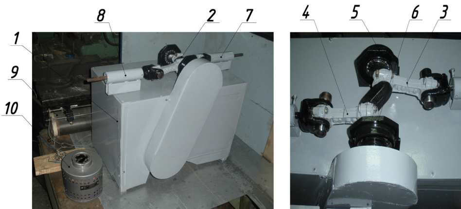
Рис. 10 - Стенд для исследования износостойкости втулок (обозначения в тексте)
