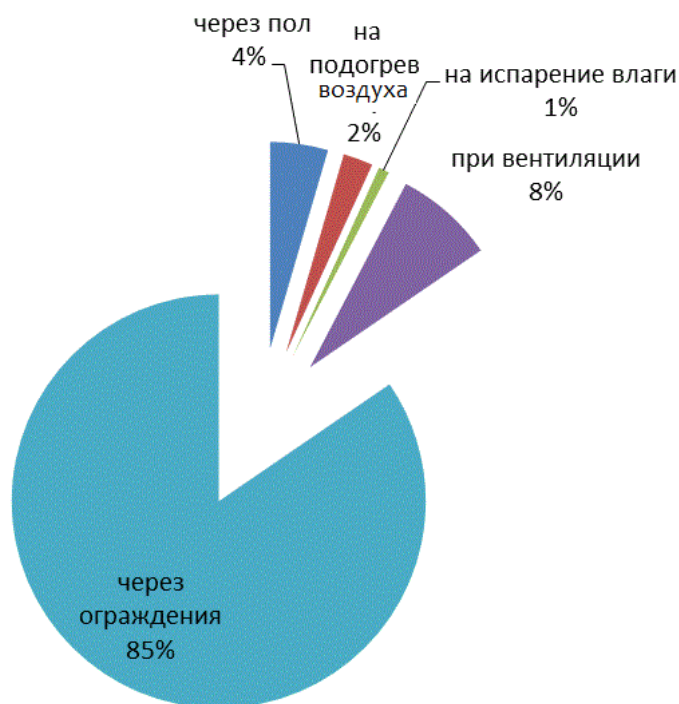
Рис. 1 - Составляющие потерь теплоты животноводческого помещения в зимний период
