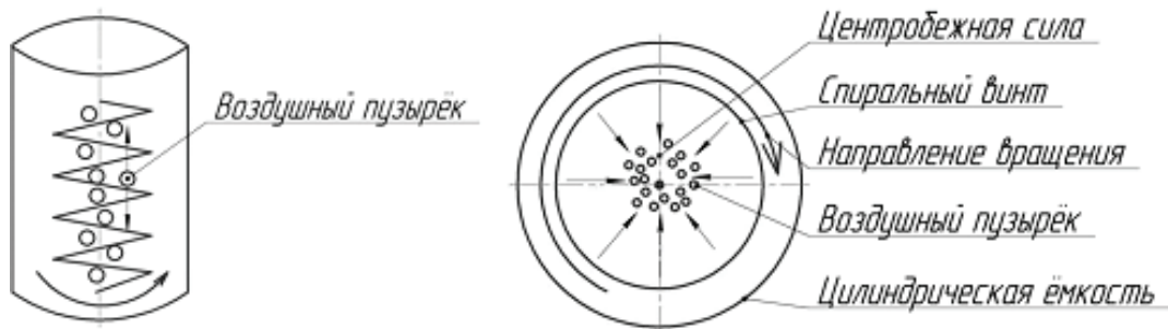
Рисунок 1 – Распределение пузырьков в толще сливок при вращении рабочего органа
