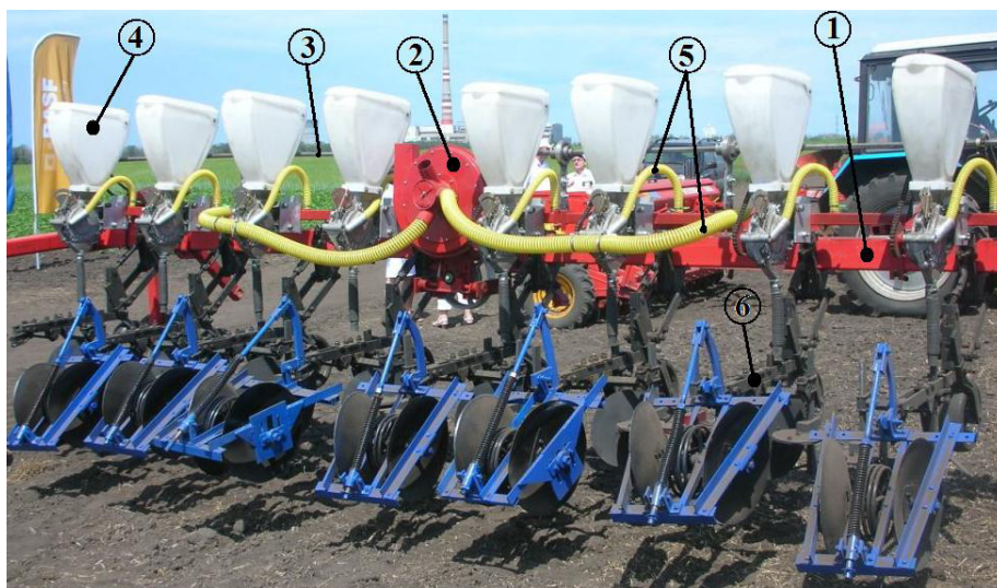
Рис. 1 – Гребневая сеялка: 1 – рама сеялки; 2 – вентилятор; 3 – приводной вал; 4 – семенной ящик с высевными аппаратами; 5 – воздухопроводы; 6 – посевная секция
