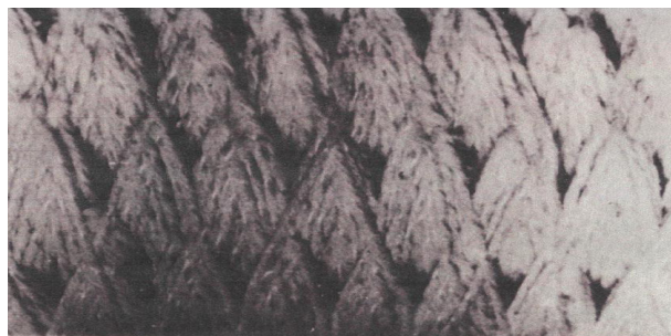
Рис. 2 – Внешний вид аэратора спиралевидной структуры намотки
