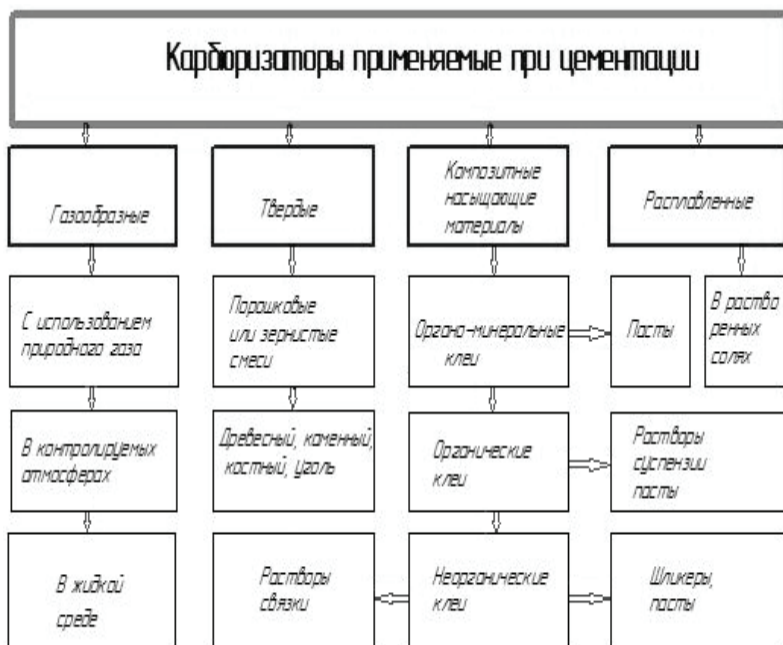
Виды карбюризаторов применяемых при цементации
