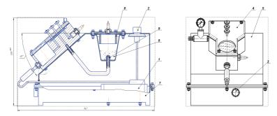
1 блок управления, 2 блок сигнальный, 3 кнопка ПМ, 4 камера испытательная, 5 корпус верхний, 6 корпус защитный, 7 корпус нижний, 8 камера пескоструйная, 9 наконечник.
