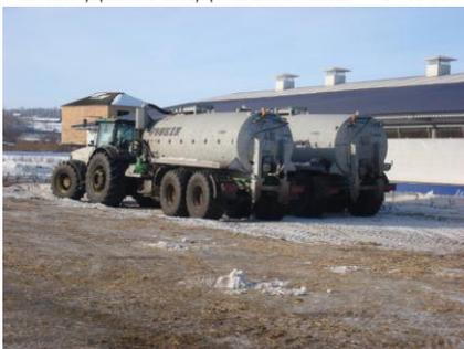
*Рисунок 5 - Машина для внесения жидких органических удобрений*
