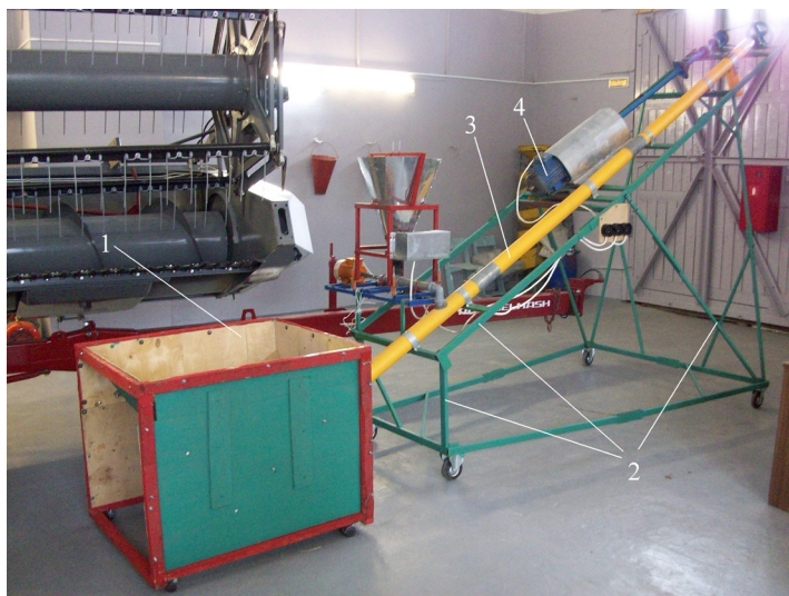
1 – приёмный бункер; 2 – рама; 3 – кожух; 4 – электродвигатель.
