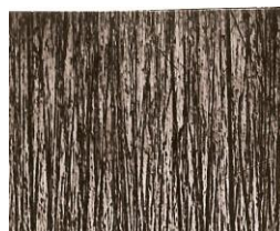
Рисунок 2 – Топография поверхности закаточных роликов после использования MAO, × 100.
