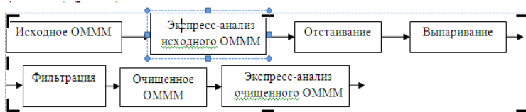
Рисунок 1 - Технологическая схема очистки отработанного моторного масла
