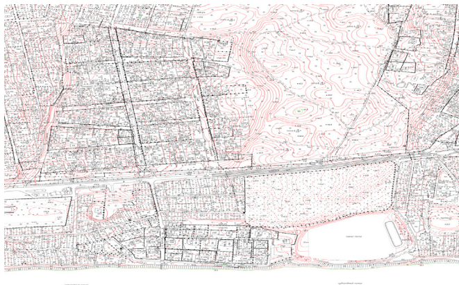
Рис.1. – Результаты наземной (тахеометрической) съёмки масштаба 1:2000 (жилой массив Комсомольского района г.о. Тольятти)
