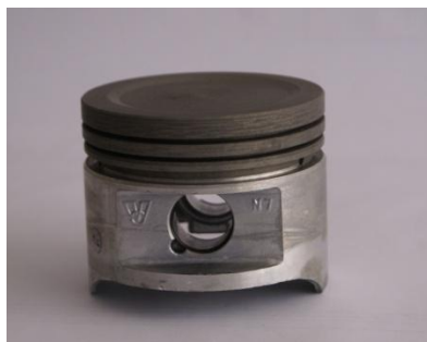
Рисунок 2 – Поршень с оксидированным днищем и канавками под поршневые кольца
