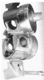
Рисунок 1 – Отливка поршня дизельного двигателя Д-240 производства Минского моторного завода
