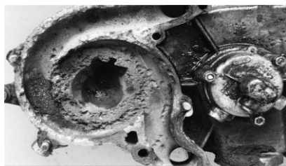
Рисунок 1 - Изношенная поверхность под крыльчатку водяного насоса крышки распределительных шестерён двигателя ЗМЗ-53 из литейного алюминиевого сплава.
