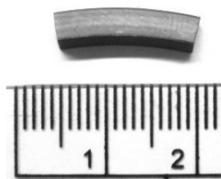
Рисунок 2 – Образец для исследования на установке ДРОН-3М
