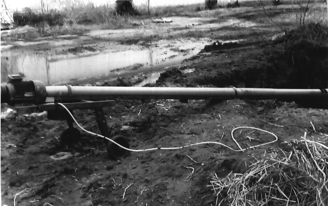
Рисунок 1 – Общий вид насоса-транспортера полужидкого и жидкого птичьего помета
