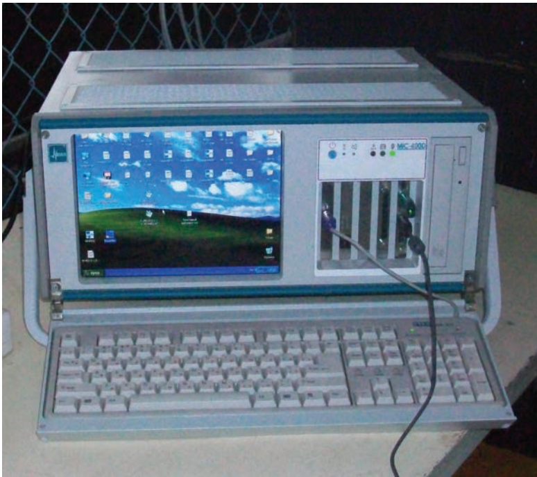
Рис. 2. Универсально мобильный многоканальный измерительный комплекс MIC-400D
