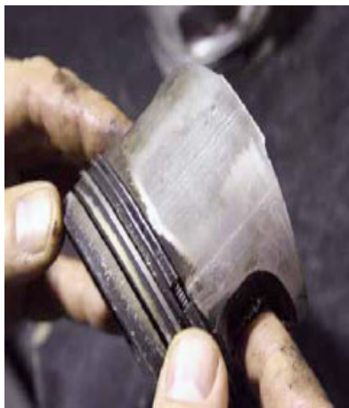
Рис.4-Абразивный износ поршня
