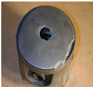
Рис.1-износ при калильном зажигании
