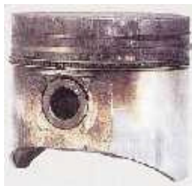
Рис.3-Задир ы на юбке поршня
