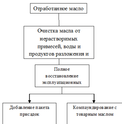
Рисунок 2 – Способы восстановления эксплуатационных свойств отработанных масел
