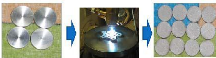
Исходные образцы (Сталь 3 и Д16) – диаметр 20мм, h16мм.
