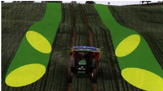
Рисунок 3 - Принцип работы N-сенсора
