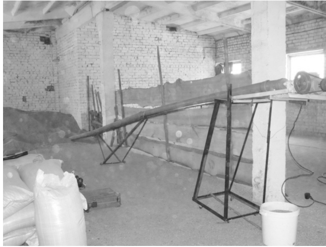
Рисунок 1 –Производственные исследования транспортера в кожухе круглого сечения
