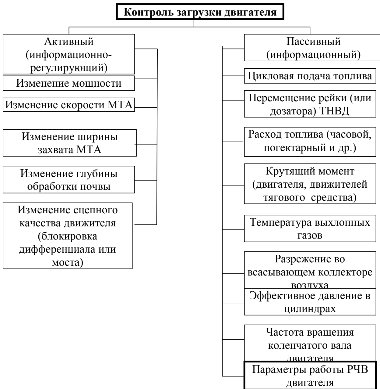
Рисунок 2 – Классификация способов контроля загрузки двигателя по эксплуатационным показателям
