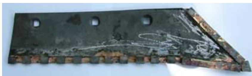
Рисунок 2 – Лемех, напаянный с лицевой стороны металлокерамическими пластинами с использованием водородно-кислородного пламени прерывисто-сплошным расположением пластин
