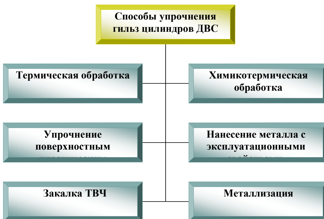
Рисунок 1 – Способы упрочнения гильз цилиндров ДВС
