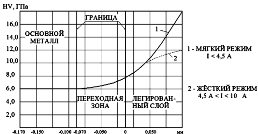
Рисунок 2-Изменение состава и твердости по толщине легированного слоя
