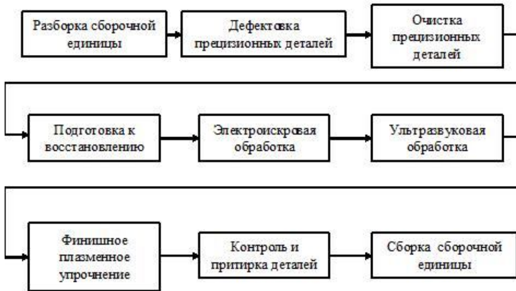
Рисунок 2 - Схема комбинированной технологии восстановления и упрочнения.
