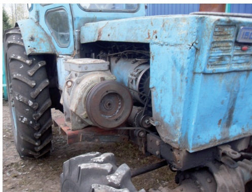
Рис. Трактор Т – 40АН с установленным на нем генератором ЕС– 52– 4Т2
