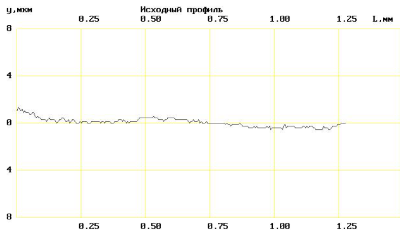
Рис. 4. Профилограмма поверхности образцов после испытаний на машине трения СМТ-1 (режим приработки)
