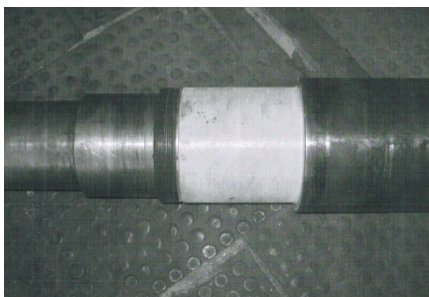
Рис. 2. Вал после нанесения восстановительного композитного материала. [4]
