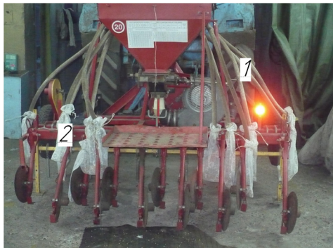
Рис. 5. Измерение массы семенного материала подаваемого в сошник
