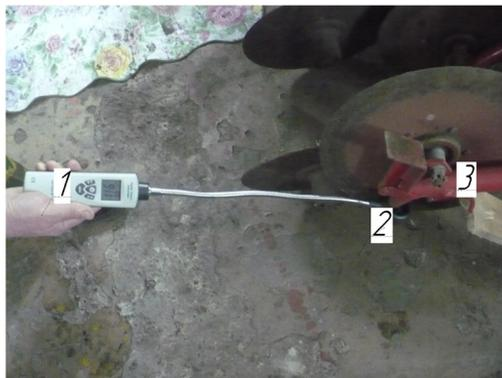
1 – анемометр электронный; 2 – датчик анемометра; 3 – семяпровод
