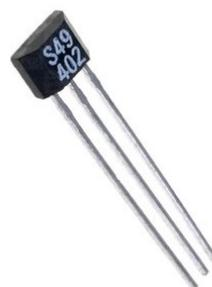
б) микросхема датчика Холла
