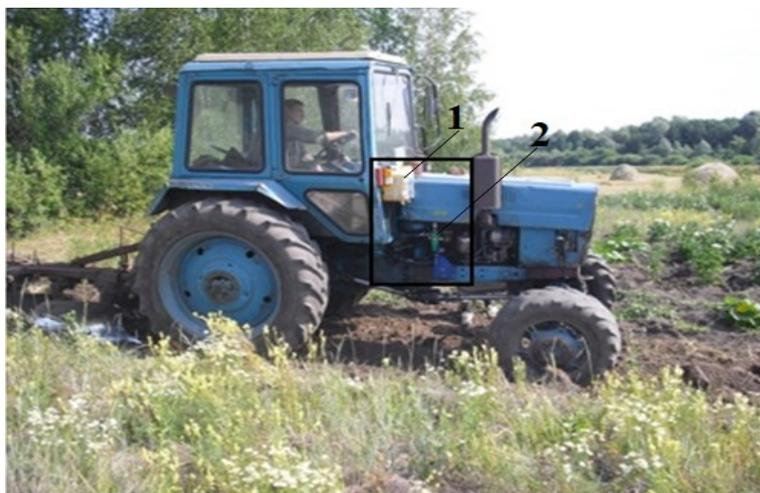
Рис. 6. Тракторный агрегат для проведения лабораторно-полевых исследований: 1 – мерные баки НДТ и РМ; 2 – смеситель НДТ и РМ
