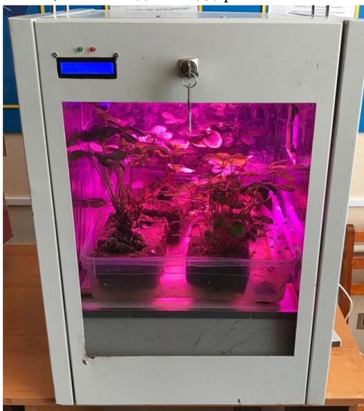
**Рис. 1 – Разработанная гидропонная установка**
